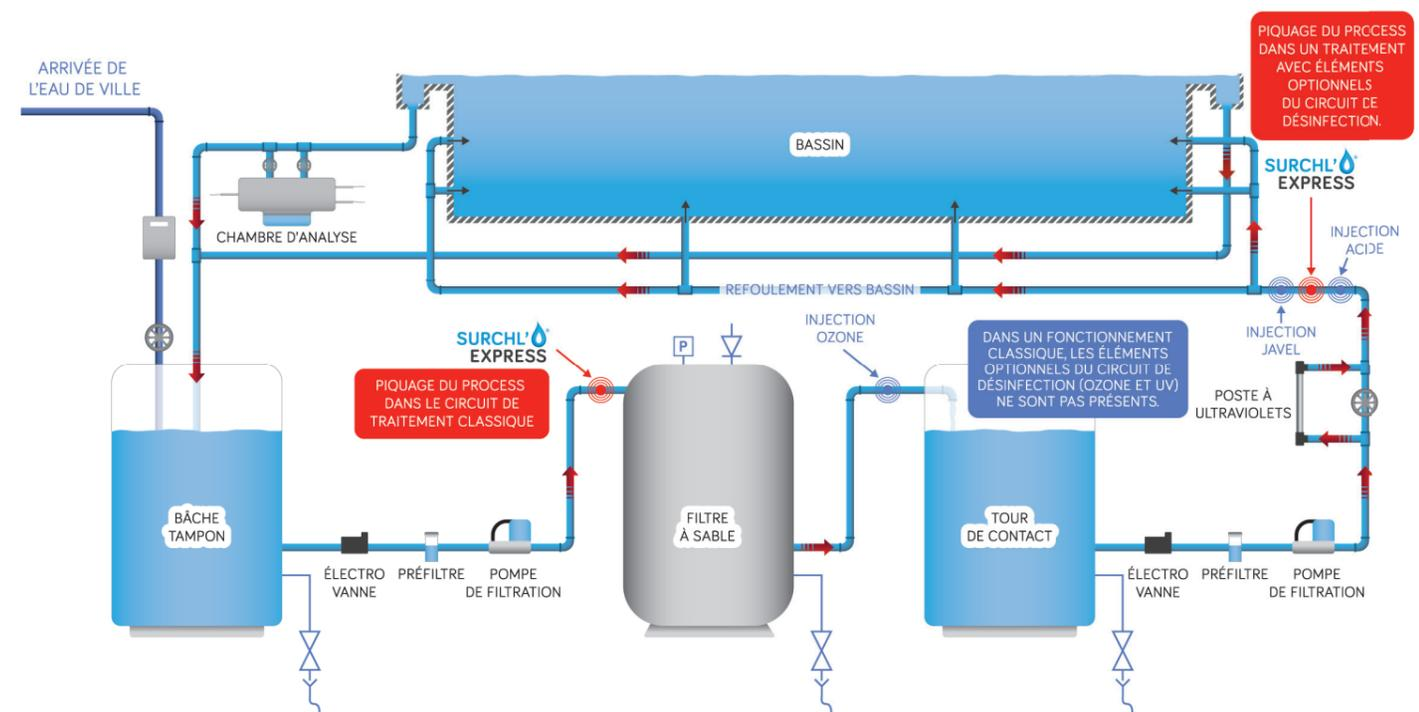
**Circuit classique :** bâche tampon, électrovanne, pompe de filtration et filtre à sable.
